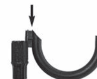
Способ монтажа консолей в головке
