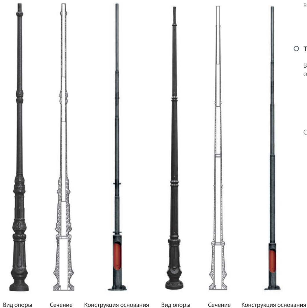
Пример конструкции опоры S- 40W
