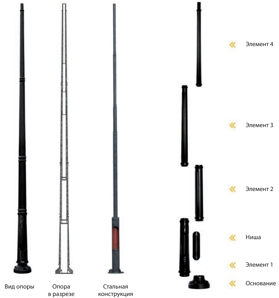
Схема конструкции опоры типа SP-4W
