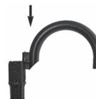
Способ монтажа консолей в головке
