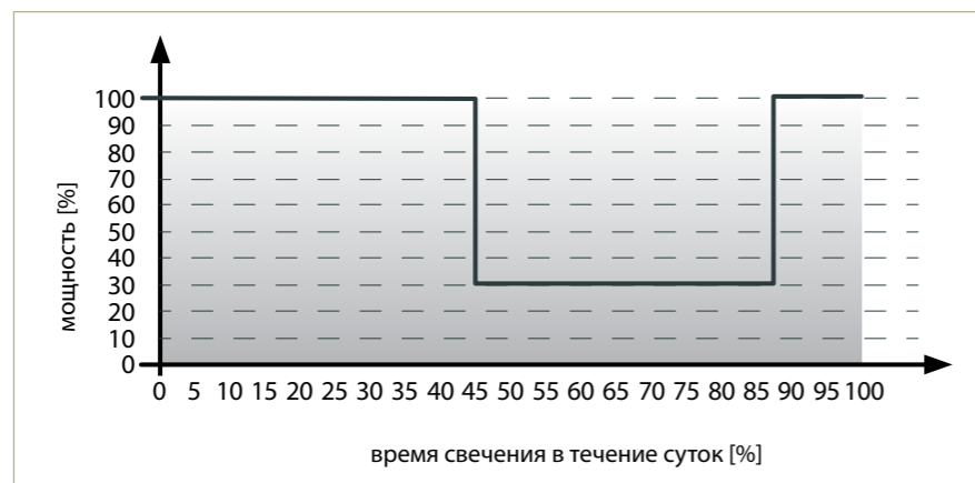
Схема экономии при уменьшении мощности в светильниках LED
