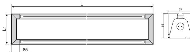
Подвесной светильник из алюминиевого профиля квадратного поперечного сечения. В комплект поставки входят 2 призматических рассеивателя.
