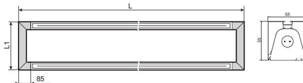
Подвесной светильник двухламповый из алюминиевого профиля квадратного поперечного сечения. Оснащен электронным пускорегулирующим аппаратом. В комплект поставки входят 2 призматических рассеивателя.
